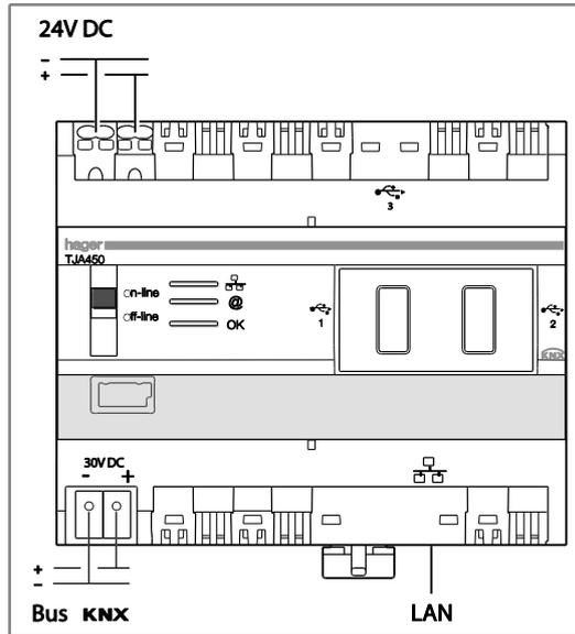
HINWEIS: Sollte kein Multimedia-Verteiler vorhanden sein, kann der Server im elektrischen Verteiler installiert werden. In diesem Fall müssen die Anschlüsse für Kleinspannung und Schutzkleinspannung auf geeignete Weise gesichert werden.
