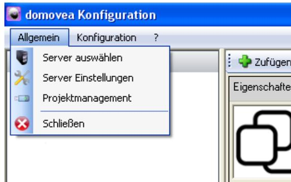
**Server auswählen:** ermöglicht die Auswahl eines Servers. Die Auswahl erfolgt automatisch beim Start des Konfigurationstools, es ist jedoch auch möglich, in diesem Fenster einen anderen Server zu wählen.
