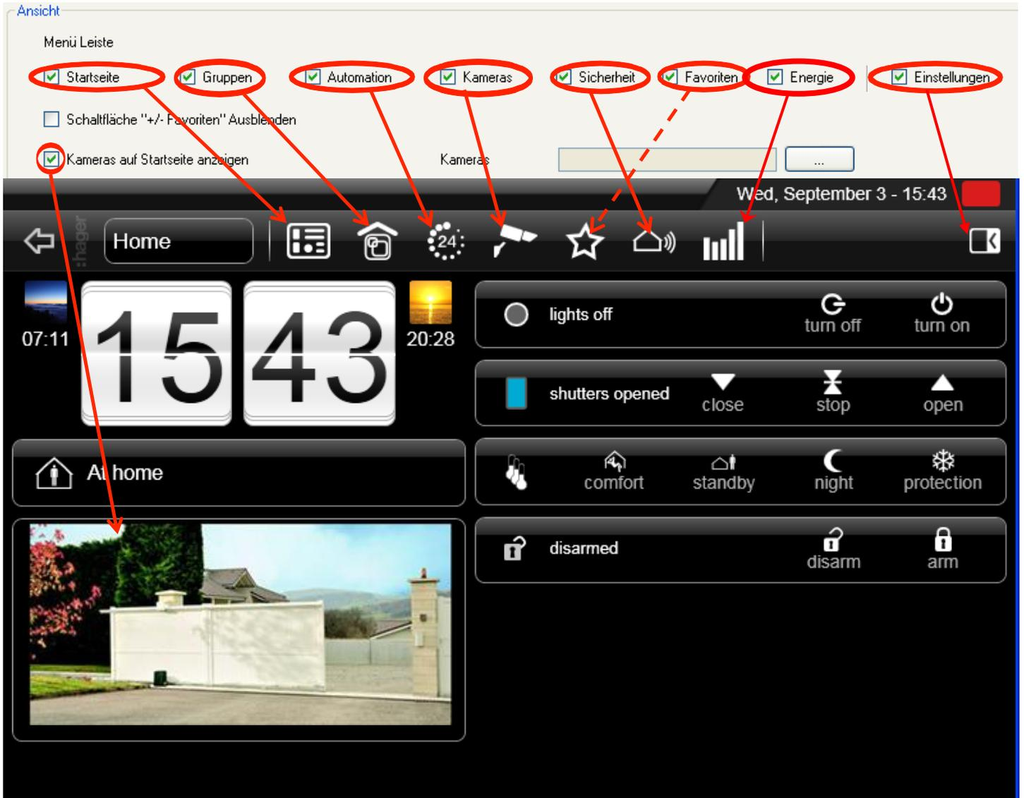
Auf der Startseite können Sie auch die Bilder einer oder mehrerer Kameras im wechsel anzeigen:
