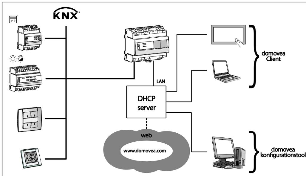
HINWEIS: Die Verbindung mit dem Portal domovea.com erfolgt über eine VPN-Verbindung.
