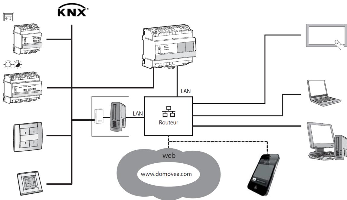
Das System domovea basiert auf den zwei unterschiedlichen Netzen eines Gebäudes:
